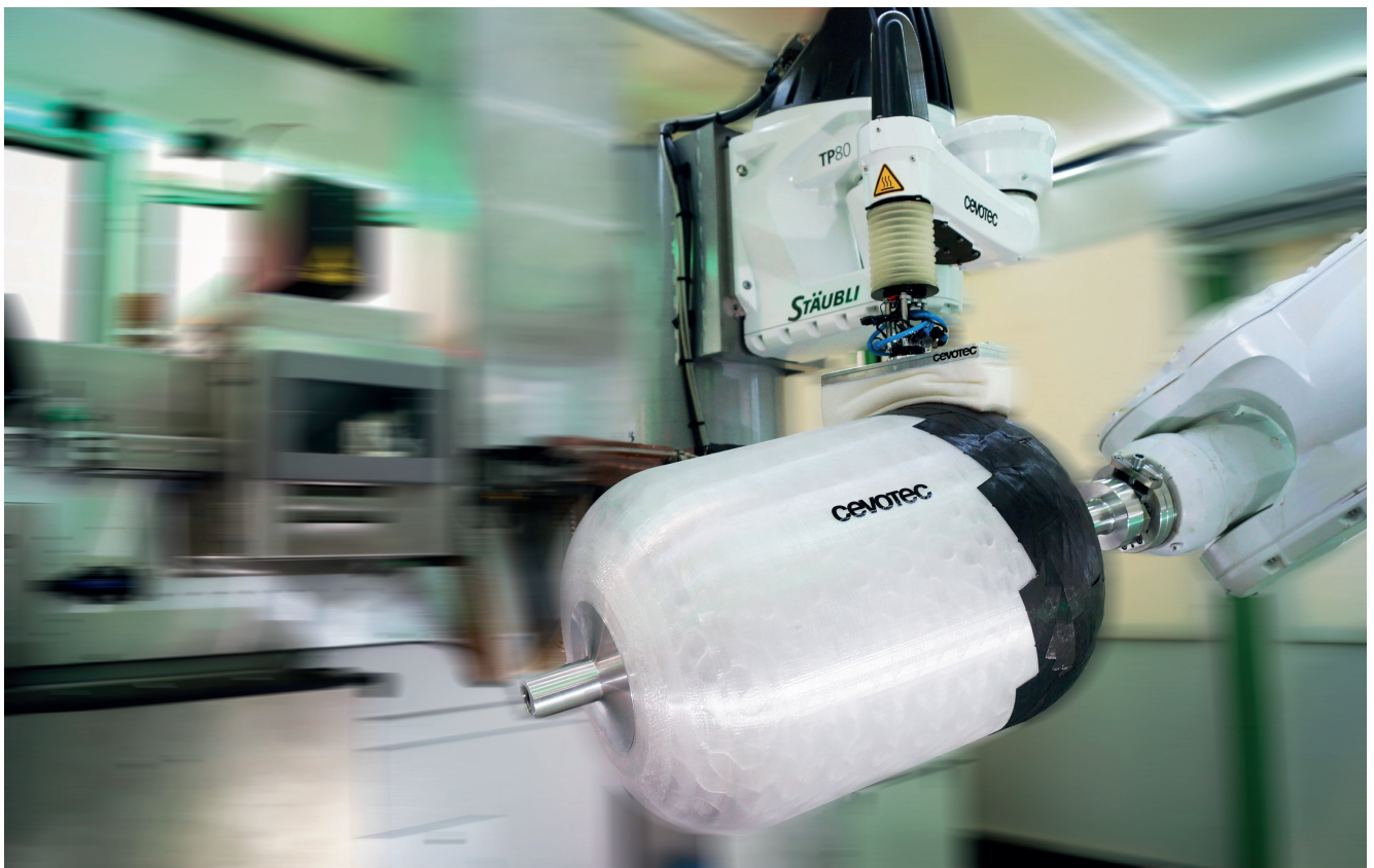
Laminatverstärkung filamentgewickelter Drucktanks. Die Ausprägung der Patches und des Greifers ist an die Größe und Komplexität des Bauteils angepasst. © Cevotec
