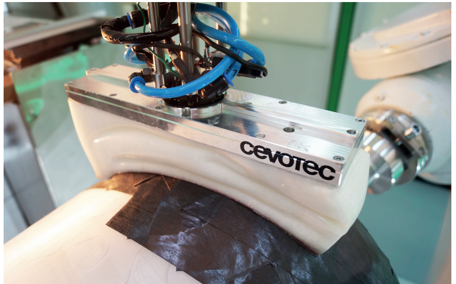
Bild 4. Das Robotersystem platziert die verstärkenden Patches direkt auf den Kuppelbereichen des Drucktanks. © Cevotec
